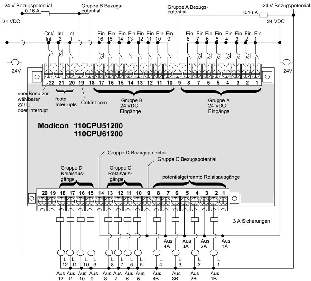
**Hinweis** Für den Schutz der Ein- und Ausgänge wird der Einsatz von flinken Sicherungen empfohlen.
