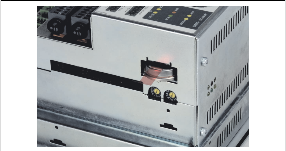
Abbildung 104: Power Panel 41 - Batteriewechsel
